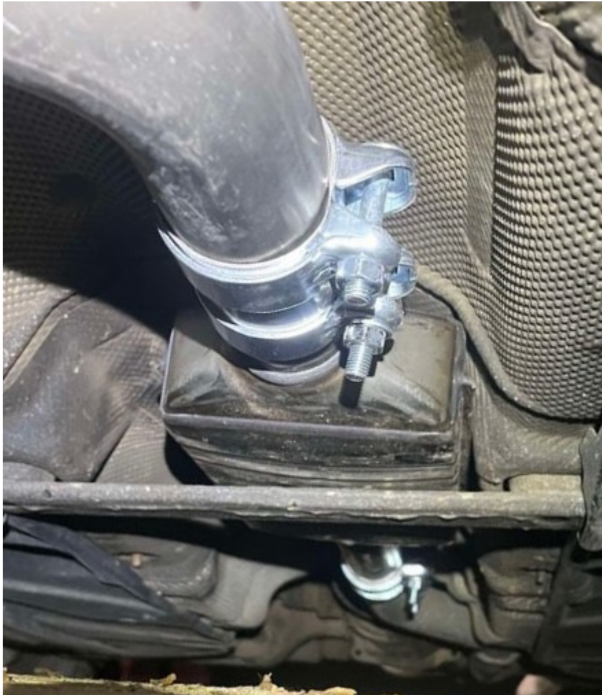
Filterenheden går tæt på tværstiver, som evt. skal bøjes i bue nedad, eller forskydes nedad med afstandsstykker imellem stiver og karosseri.
